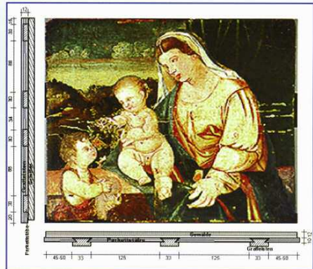
Tafelgemälde "Madonna mit Kind und Johannesknabe" (Italien, 15. Jh) Oben: Vorderseite mit Skizzen der rückseitigen Parkettierung. Unten: Darstellung der gewonnenen dreidimensionalen Daten in MS-Excel. Es ist deutlich eine konvexe Verformung der Tafel sichtbar.
